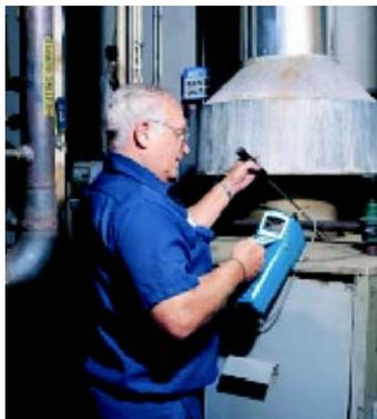
P-TRAK™ 可检测直径小于0.1微米的粒子，并对其进行计数。一般认为，这一部分微粒常常伴随着污染物的存在，因此可以通过 P-TRAK™ 的检测对污染源进行
